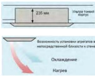
Простая интеграция в системы кондиционирования в соответствие с индивидуальными особенностями помещений. (Сверхтонкий корпус позволяет производить установку агрегата даже в условиях ограниченно-го пространства).
