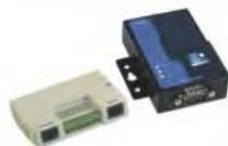
Опция является преобразователем внутреннего протокола контроллера в открытый протокол BASnet, используемый в системе комплексного управления и диспетчеризации здания.
